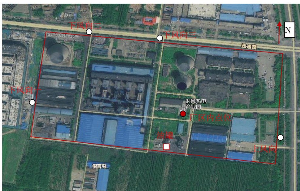
图 2.4-4 (1) 厂界例行无组织排放监测示意图
